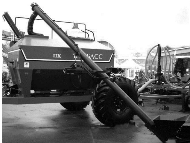
Рис. 6.5.3. Шнек в положении «загрузка»
