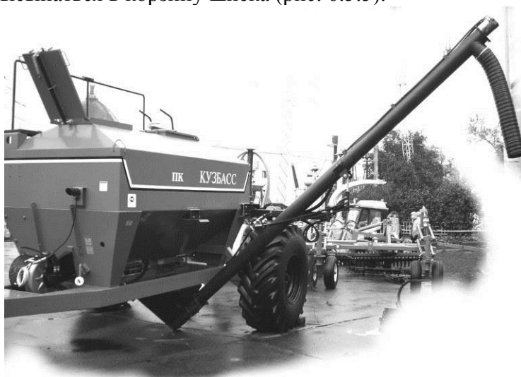
Рис. 6.5.4. Шнек в положении «разгрузка»
