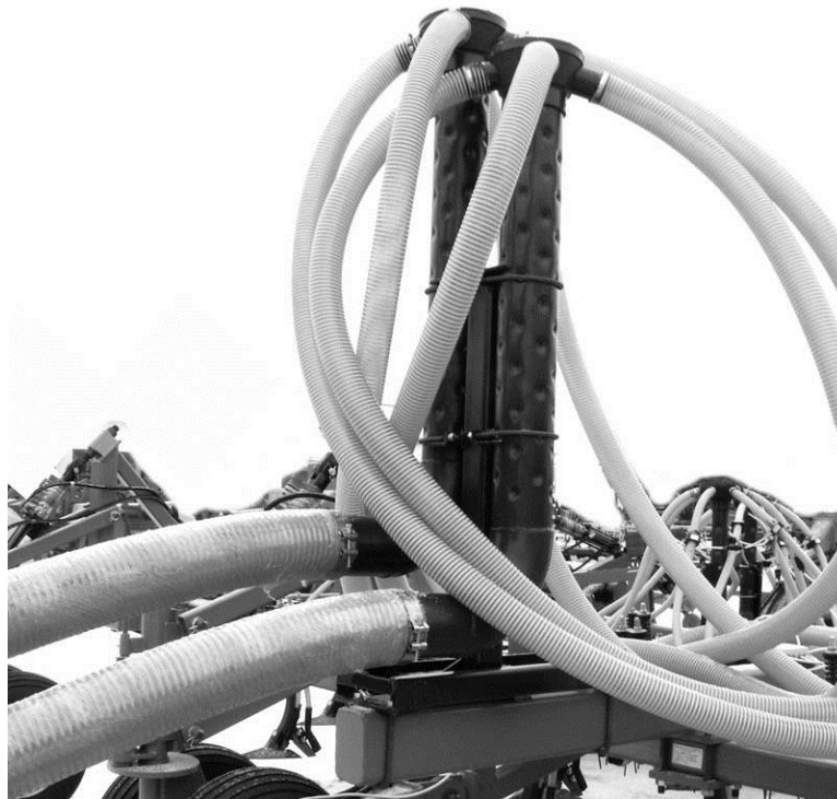
Рис. 4.10.2.1. Сборка первичного коллектора для ПК раздельным высевом семян и удобрений.
