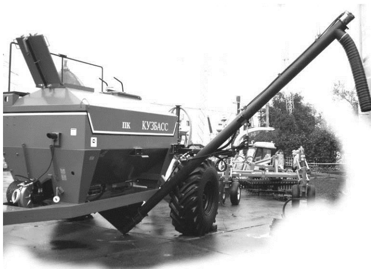
Рис. 6.5.4. Шнек в положении "разгрузка"
