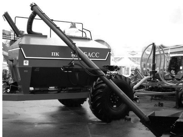
Рис. 6.5.3. Шнек в положении "загрузка"
