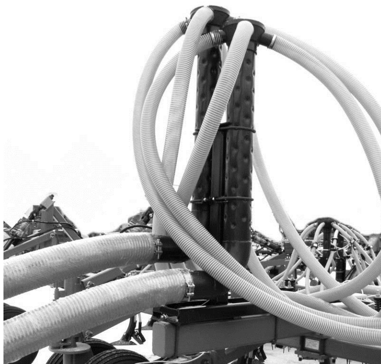
Рис. 4.13.2.1. Установка первичного распределителя на ПК раздельным высевом семян и удобрений.
